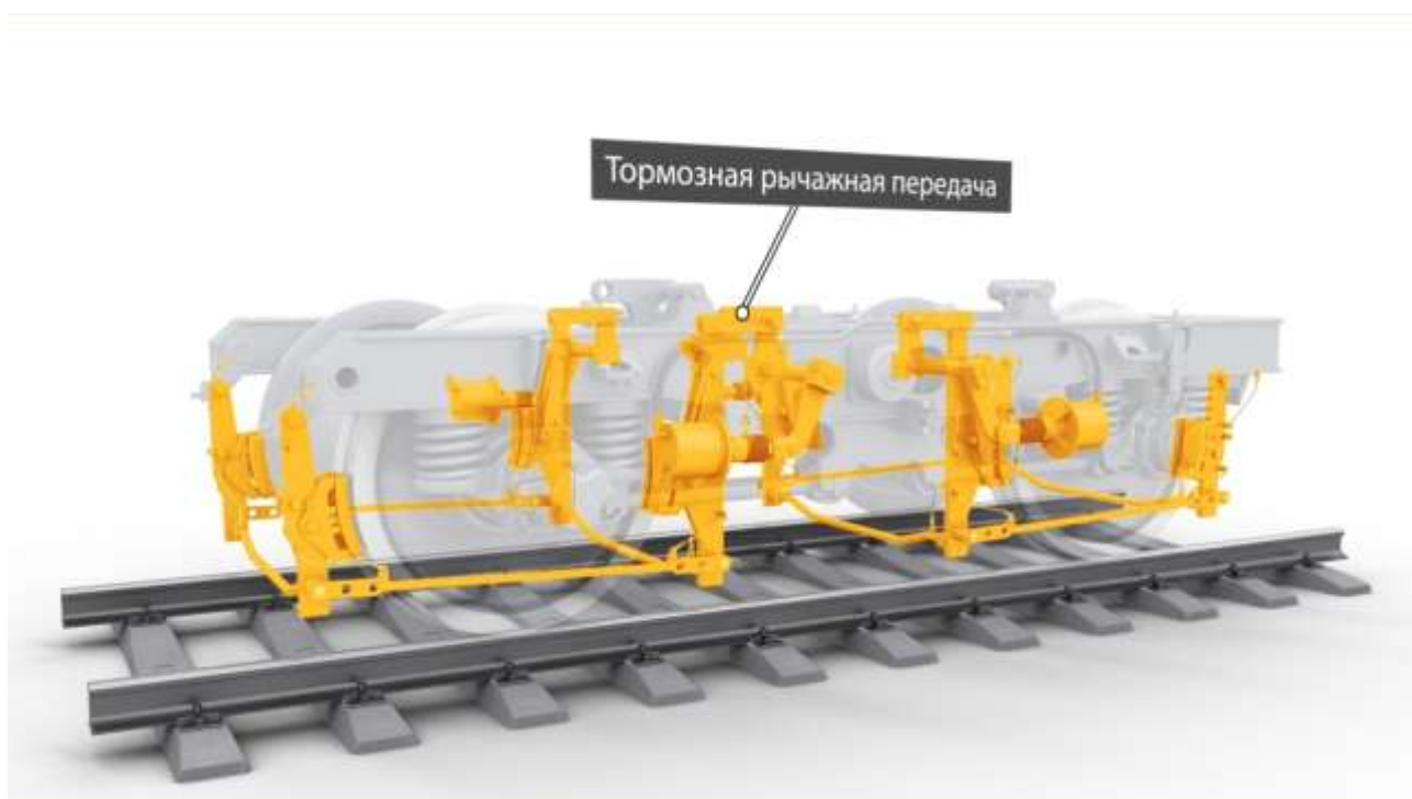
Рисунок 2.11 Тормозная рычажная передача
