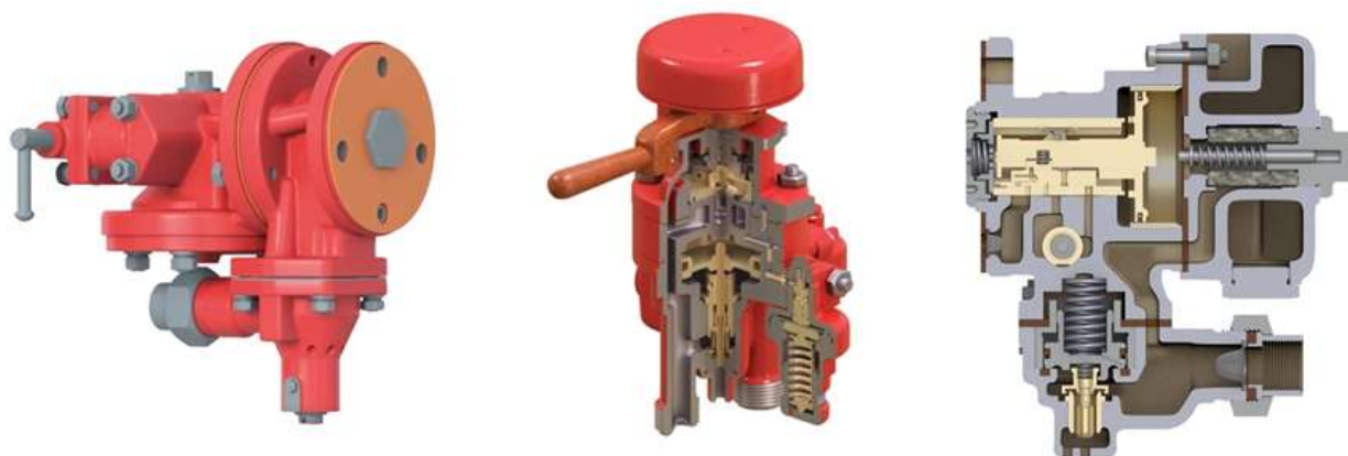
Рисунок 2.23 Учебный комплекс «Тормозное оборудование электропоездов серии ЭД. раздел приборы торможения и управления тормозами»
