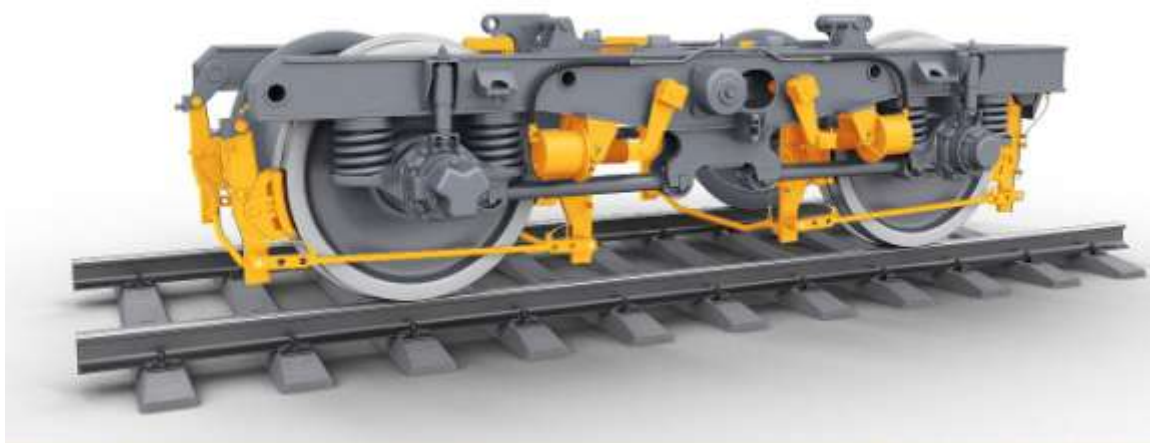
Рисунок 2.18 Элементы тормозной рычажной передачи
