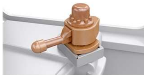
Кран 215 вспомогательного тормоза локомотива
